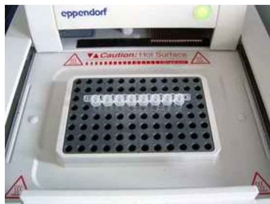
Bild oben: Variationen von VNTR-Allelen bei sechs verschiedenen Individuen, Bild unten links: Zwei Thermozykler, unten rechts ein geöffneter Thermozykler
